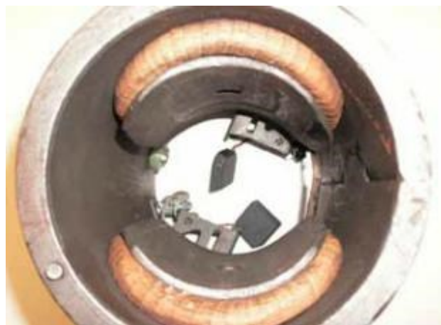
Slika 1 - zavojnice polja na statoru omotane oko tzv. polnih papuča
